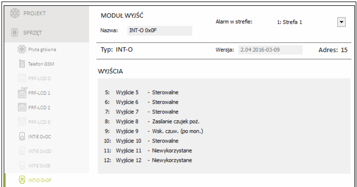
Rys. 12. Zakładka z ustawieniami ekspandera wyjść.
