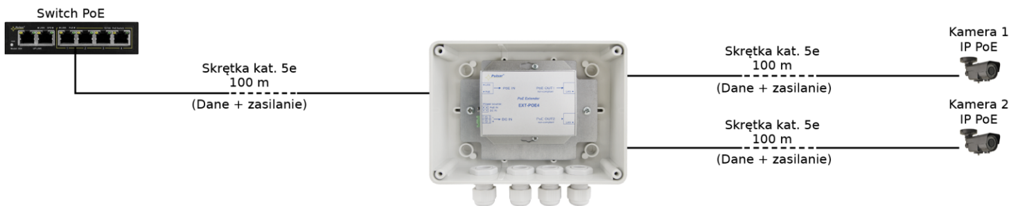
Podłączenie dwóch kamer IP PoE i wydłużenie zasięgu o kolejne 100m
