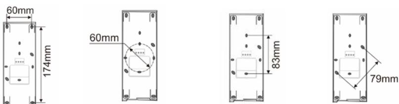
1. Zadní část přístroje obsahuje otvory pro šrouby, skrze něž lze přístroj připevnit na zeď při dodržení výše uvedených rozměrů.
